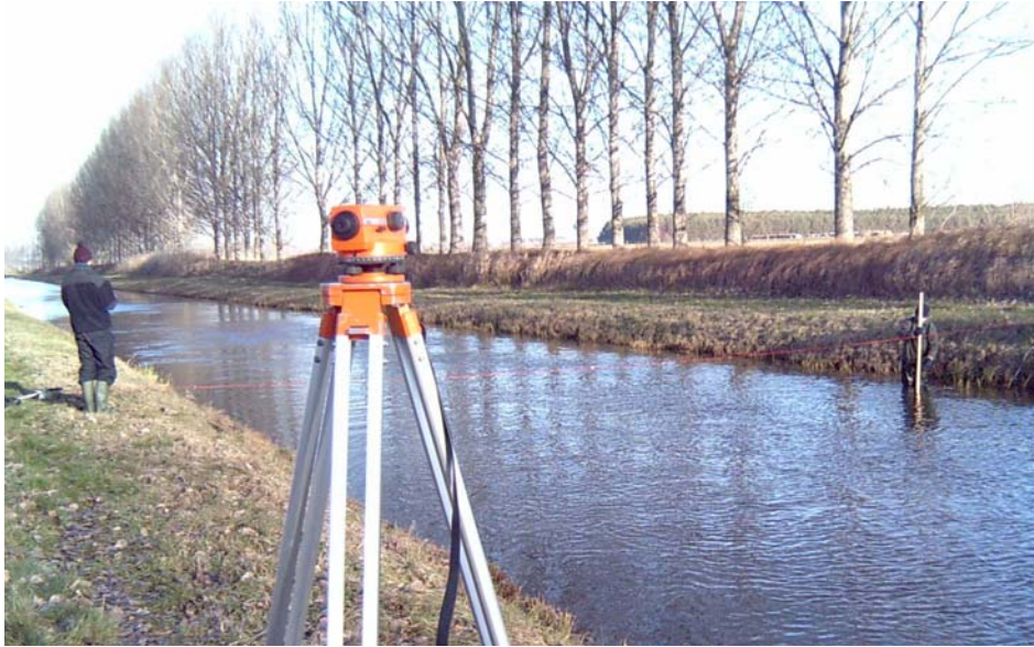
Abb. 4-3 Vermessung der Querprofile oberhalb des Wehres Trebbin im Dezember 2003
